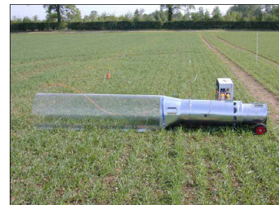
Tunnel de ventilation permettant la mesure des émissions d'ammoniac au champ
